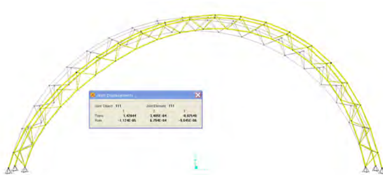
Fig.25: Geometria deformada ampliada – Combinação de Cargas 1 (TENSOR Estruturas Especiais e Tecnologia)
