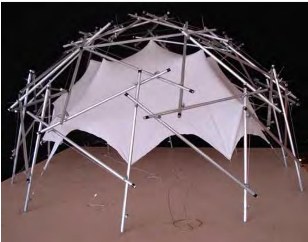
FIGURA 16 – Cobertura tensoestruturada interna à geodésica *Tensegrity*.
