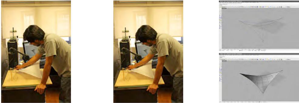
Figuras 2, 3 y 4. Se muestra el escaneado 3D por puntos del modelo físico de una velaría y el resultado de la superficie pretensada en el software Rhinoceros.
