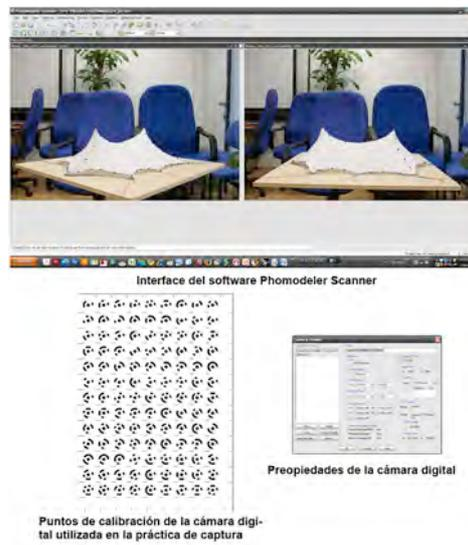
Figura 5. Muestra la interface del Software PhotoModeler Scanner con un proceso fotogramétrico de un modelo físico de una velaría.
