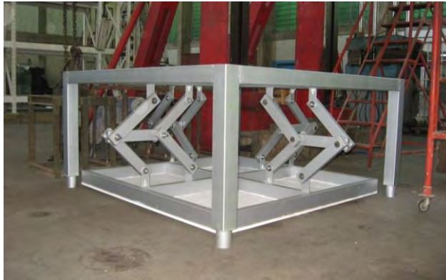
Figura 8 Mecanismo para mantener la horizontalidad del marco.
