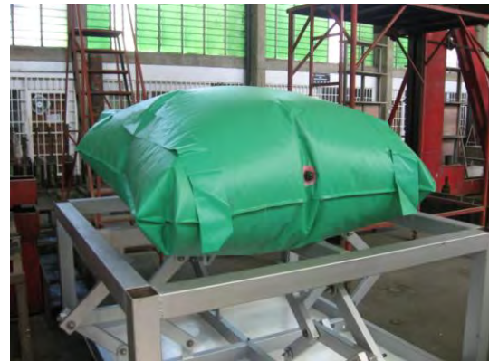
Figura 8 Mecanismo para mantener la horizontalidad del marco.
