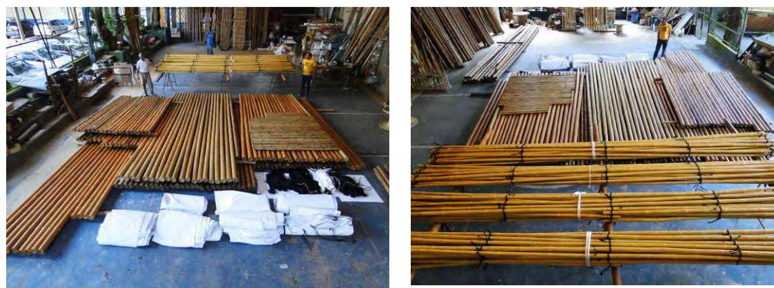
Figuras 23 e 24 – Materiais componentes da estrutura do galpão, com exceção das fundações. Estrutura desmontada, em módulos compactos pesando um total de 2,5 toneladas.
